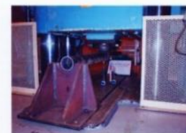
タイガーパイル曲げ試験状況 (試験後)
